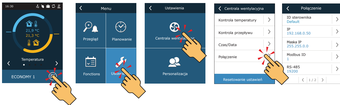
Rys. 26. Adres IP można zobaczyć i zmienić na panelu sterowniczym
