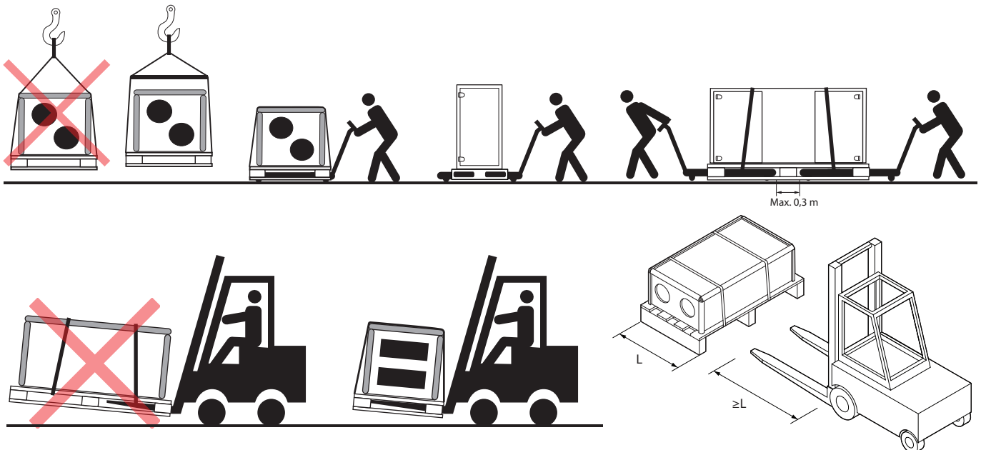
Rys. 5. Przykłady transportu dźwigiem, wózkiem widłowym lub paletowym
