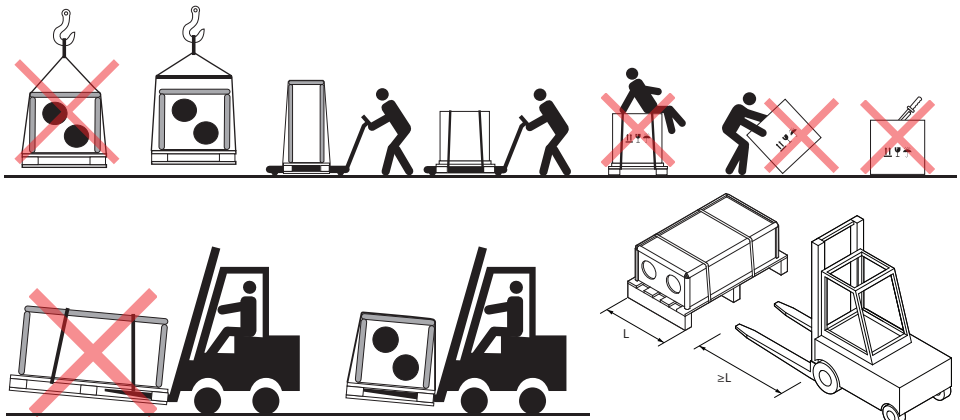
Rys. 4. Przykłady transportu dźwigiem, wózkiem widłowym lub paletowym.
